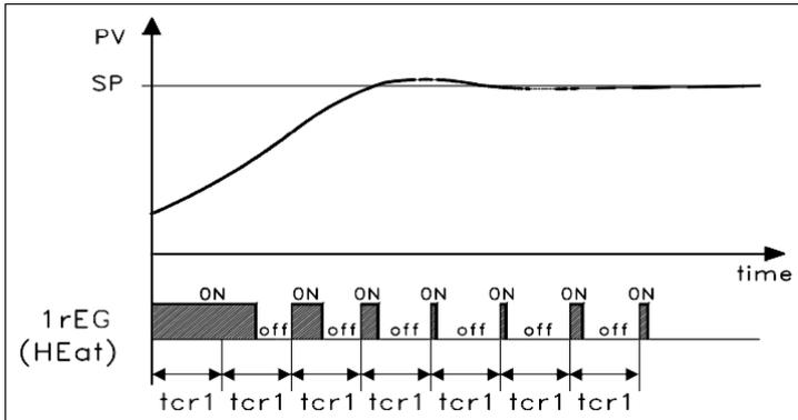
Pour obtenir une bonne stabilité de la variable dans le cas de procédés rapides, le temps de cycle "tcr1" doit avoir une valeur basse avec une intervention très fréquente de la sortie de réglage.
