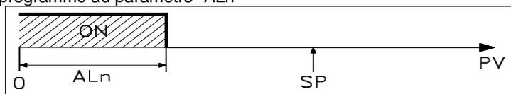
HiAb = ALARME ABSOLUE DE MAXIMUM: L'alarme est activée quand la valeur de procédé monte au-dessus du seuil d'alarme programmé au paramètre "ALn"
