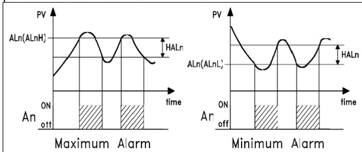
Pour les alarmes à fenêtre l'exemple de l'alarme de minimum s'applique au seuil inférieur ("ALnL") alors que l'exemple de l'alarme de maximum s'applique au seuil supérieur ("ALnH").
