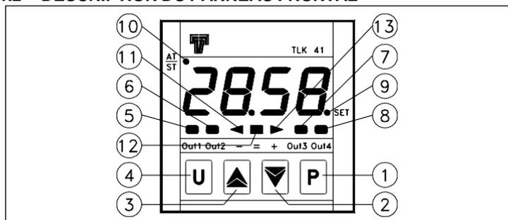
**1 - Touche P** : Utilisée pour accéder à la programmation des paramètres de fonctionnement et pour confirmer la sélection.
