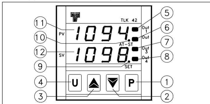
**1 - Touche P** : Utilisée pour accéder à la programmation des paramètres de fonctionnement et pour confirmer la sélection.
