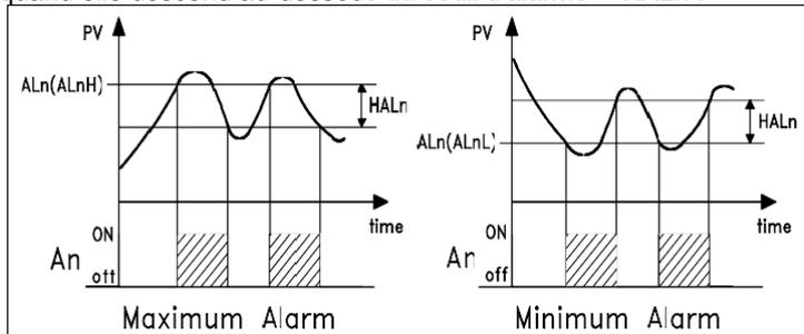
Pour les alarmes à fenêtre l'exemple de l'alarme de minimum s'applique au seuil inférieur ("ALnL") alors que l'exemple de l'alarme de maximum s'applique au seuil supérieur ("ALnH").
