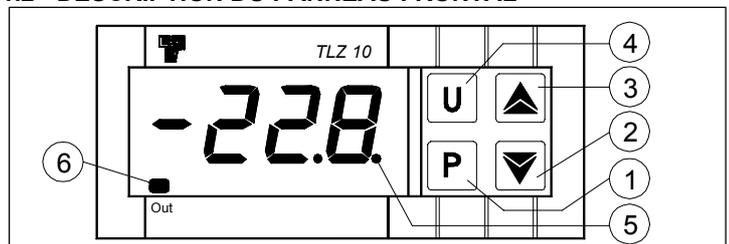
**1 - Touche P** : Utilisée pour l'établissement du Set point et pour la programmation des paramètres de fonctionnement
