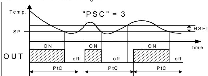
La fonction résulte déconnectée en programmant "PtC" = 0. Pendant les phases de retard de l'allumage de la sortie OUT pour interdiction de la fonction "Compressor Protection" le led OUT est clignotant.
