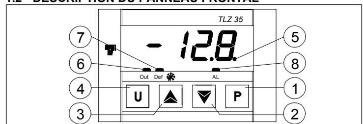
**1 - Touche P** : Utilisée pour l'établissement du Set point et pour la programmation des paramètres de fonctionnement
