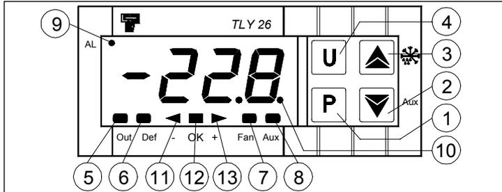
**1 - Touche P** : Utilisée pour la programmation du Set point et pour la programmation des paramètres de fonctionnement.
