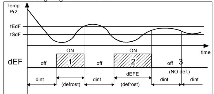
**Exemples :** le dégivrage 1 termine pour la réalisation de la température "**tEdF**", le dégivrage 2 termine à la fin du temps "**dEFE**" car la température "**tEdF**" n'est pas réalisée, le dégivrage 3 ne s'effectue pas car la température est supérieure à "**tSdF**".
