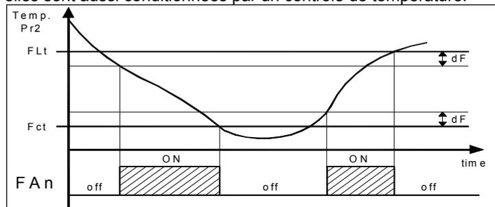
On peut en effet établir la déconnexion des hélices quand la température mesurée par la sonde Pr2 est supérieure à ce qui est établi au par. "FLt" (température trop chaude) ou quand elle est inférieure à ce qui est établi au par. "Fct" (température trop froide).
