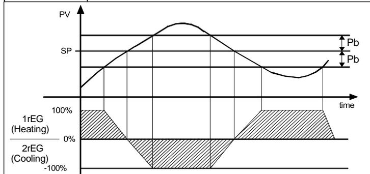
**N.B. :** Pour simplifier l'explication dans les graphiques d'exemple, on a considéré un régulateur seulement proportionnel (et donc avec "dEr" et "Int" = OFF) à double action avec "Prat" = 1.0 et "rS" = 0.0
