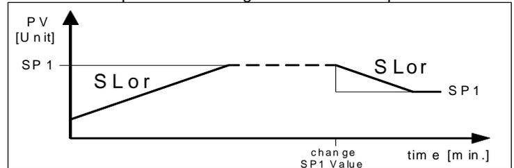
Si on désire par contre réaliser un cycle automatique après l'allumage de l'instrument il faut programmer le par. "nSP" = 2, programmer les deux valeurs "SP1" et "SP2" et naturellement programmer les par. "SLor", "dur.t" et "SLoF" avec les valeurs désirées.
