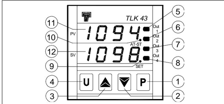
**1 - Touche P** : Utilisée pour accéder à la programmation des paramètres de fonctionnement et pour confirmer la sélection.
