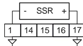
**Niveau logique 0:**  $V_{out} < 0.5$  VDC;
