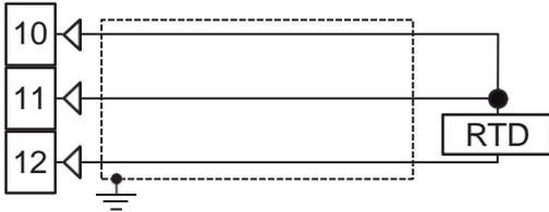
**Circuit d'entrée:** Injection de courant (135  $\mu$ A).
