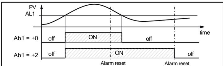
3. Une alarme "rendue silencieuse" est une alarme qui peut être remise à zéro même si la condition qui a engendré l'alarme est encore présente. La reconnaissance de l'alarme peut s'effectuer seulement par une commande externe (poussoir **U**, entrée logique ou interface série).
