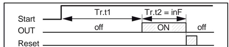
Retard à la mise en fonction avec un temps de retard et un temps de "fin de cycle".
