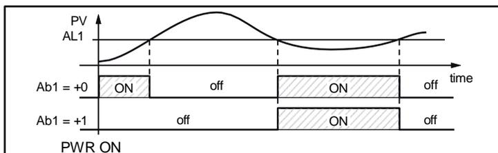
2. Une alarme mémorisée (reset manuel) est une alarme qui reste active même quand la condition d'alarme qui l'a engendrée n'est plus présente. Le reset d'alarme peut se faire seulement par une commande externe (poussoir **U**, entrée logique ou interface série).
