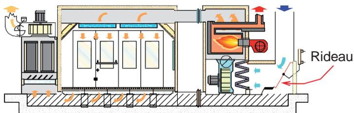
Pendant les phases de passivation et d'essiccation de la peinture, l'opérateur est à l'extérieur de la cabine et le système ferme la vanne de l'air extérieur et recycle l'air interne (déjà chaud) pour réduire la consommation d'énergie.
