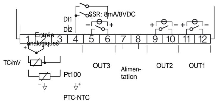
Sortie 12 VDC max. 20 mA
