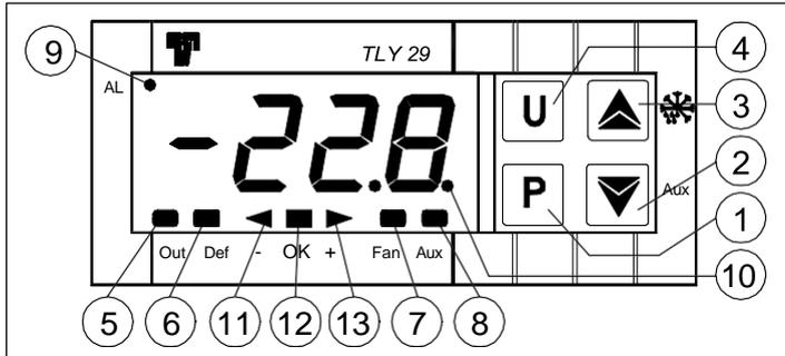
**1 - Touche P :** Utilisée pour la programmation du Set point et pour la programmation des paramètres de fonctionnement.
