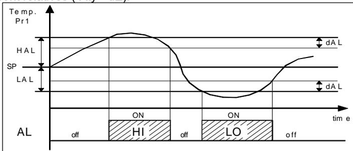
Les alarmes de température de maximum et de minimum peuvent être déconnectées en établissant les paramètres relatifs "HAL" et "LAL" = OFF.
