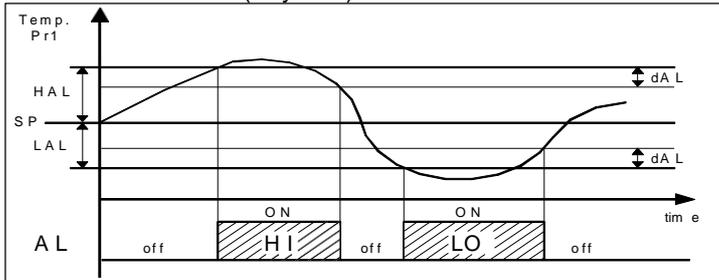
Les alarmes de température de maximum et de minimum peuvent être déconnectées en établissant les paramètres relatifs "HAL" et "LAL" = OFF.
