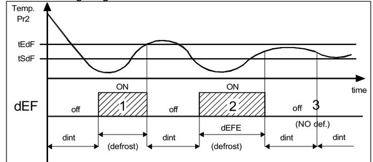
**Exemples** : le dégivrage 1 termine pour la réalisation de la température "tEdF", le dégivrage 2 termine à la fin du temps "dEFE" car la température "tEdF" n'est pas réalisée, le dégivrage 3 ne s'effectue pas car la température est supérieure à "tSdF".
