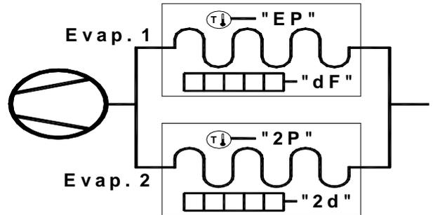
**Exemple schématique de l'usine avec deux évaporateurs avec dégivrage électrique.**
