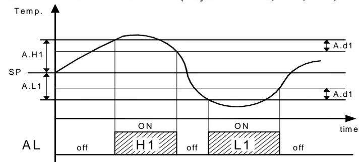
Les alarmes de température maxima et minima peuvent être désactivés en réglant les paramètres pertinents "A.Hx" et "A.Lx" = oF.
