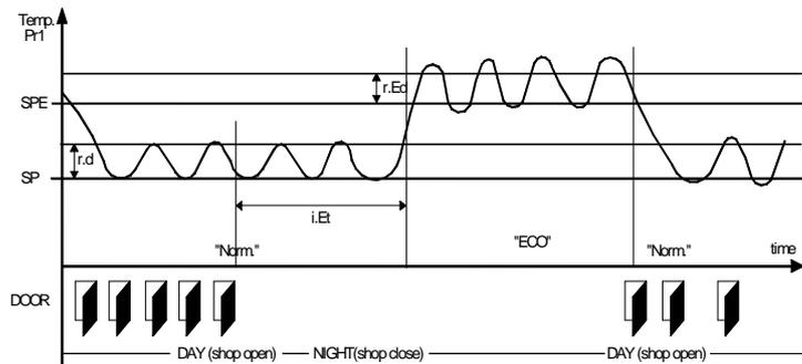
Exemple de commutation automatique entre le mode Eco et le mode normal. Pendant les heures de travail que la porte est souvent ouverte et le contrôleur reste en mode normal. Lorsque la porte n'a pas été ouverte par le temps "i.Et", le contrôleur passe en mode Eco. Dès que la porte est encore ouverte, le régulateur repasse en mode normal.
