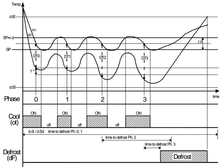
*Exemple "système dynamique des intervalles de dégivrage" avec une réduction "d.dd" = 40% et fin de dégivrage par la température.*
