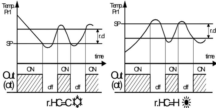
En ce qui concerne le mode de fonctionnement programmé au paramètre "r.HC", le régulateur suppose automatiquement que le différentiel a des valeurs positives pour un contrôle de Réfrigération ("r.HC" = C), valeurs négatives pour le contrôle de chauffage ("r.HC" = H).
