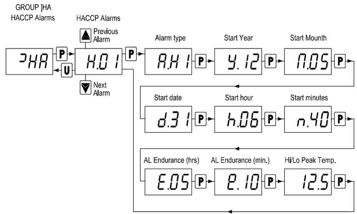
L'instrument trie automatiquement ces paramètres à partir de la plus récente (H.01) au plus vieux (H.10) chaque fois qu'une alarme est enregistré ou supprimé.
