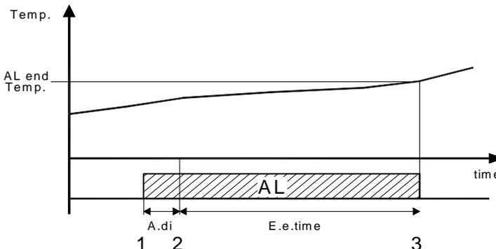
Note: En cas de panne pendant une alarme d'une entrée numérique, l'appareil enregistre la durée de l'alarme jusqu'au moment où la panne a commencé.
