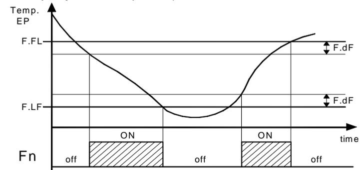
Notes: Il est nécessaire de prêter attention à l'utilisation correcte de ces ventilateurs fonctions de contrôle de la température parce que dans l'application typique de réfrigération de l'arrêt de l'évaporateur fans s'arrête échange thermique.
