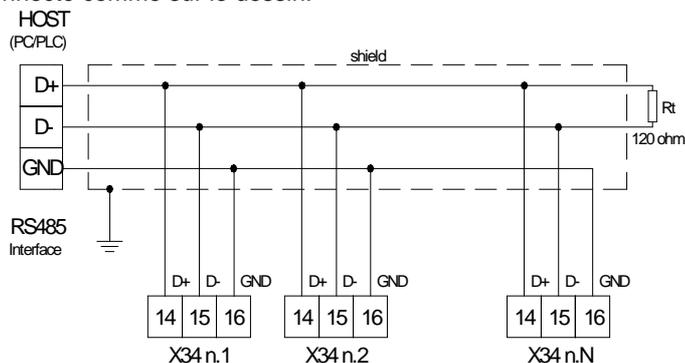
Le circuit d'interface permet de connecter jusqu'à 32 instruments sur la même ligne.
