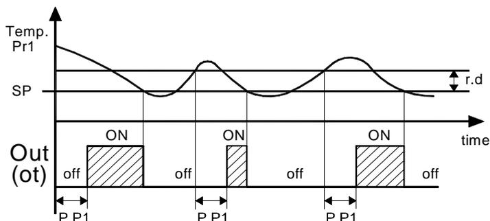
Deuxième contrôle (par. "P.P2") prévoit une inhibition de l'activation de la sortie d'un délai qui commence quand la sortie est en train de s'éteindre (retard après mise hors tension).
