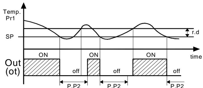
Troisième contrôle (par. "P.P3") prévoit une inhibition de l'activation de la sortie "Out" par un délai qui commence quand la sortie tournait au dernier moment (délai entre la mise en marche).
