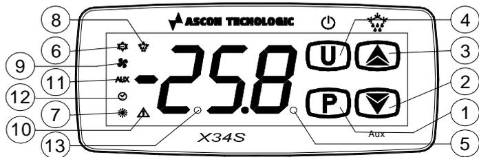
**1 - Touche P:** Utilisée pour régler le point de consigne (appui court) et pour la programmation des paramètres de la fonction (Maintenez enfoncée pendant 5 sec.)
