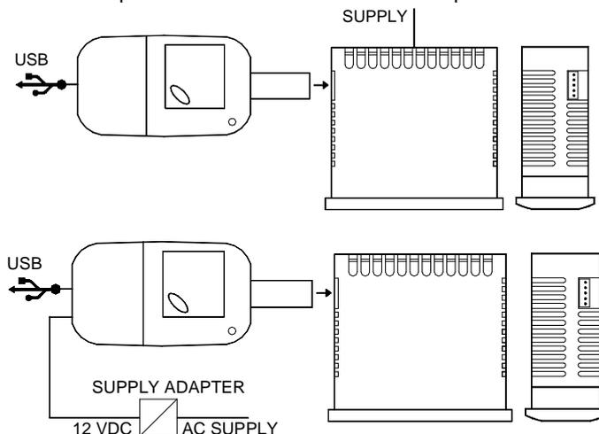
Le même appareil peut se connecter l'appareil via USB à un PC et à travers les propres outils logiciels de configuration "TECNOLOGIC de UniversalConf", il est possible de configurer les paramètres de fonctionnement.
