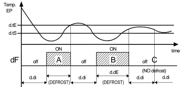
**Exemples:** Un dégivrage se termine à cause d'atteindre la température "d.tE", le dégivrage B se termine à la fin du temps "d.dE" que la température "d.tE" n'est pas atteint, le dégivrage C n'a pas lieu tant que la température est supérieur "d.tS".
