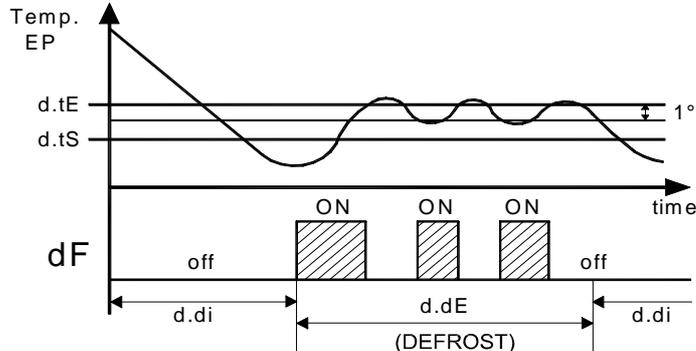
**Exemple de dégivrage électrique avec contrôle de température de l'évaporateur:** La fin de dégivrage après "d.dE" temps programmé. Pendant le dégivrage le "dF" commutateur de sortie on / off pour contrôler la température évaporateur en mode chauffage avec consigne "d.tE" et 1° différentiel (hystérésis).
