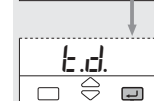
Temps dérivée imposé [3] (seulement en visualisation) (disponible si l'adaptative tune est validé)
