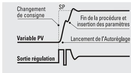
La procédure d'Autoréglage par **fréquence naturelle** du procédé est utilisée quand, au démarrage, la mesure est quasiment égale à la consigne. Les paramètres PID sont calculés à partir d'une oscillation du procédé autour de la consigne.
