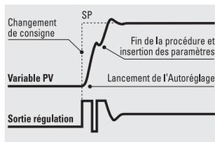
L'auto-réglage par **fréquence naturelle** du procédé est sélectionné si, au lancement de la procédure, la consigne est proche de la mesure. Dans ce cas, le régulateur provoque une oscillation du procédé autour de la consigne. Le principal avantage de cette méthode réside dans le peu de perturbation induite sur le procédé.
