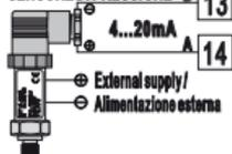
Per segnali normalizzati in corrente 0/4...20 mA con sensore ad alimentazione esterna.
