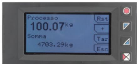
Premendo **Funzione somma** si entra nella pagina dedicata. Premendo **+** si somma il valore **Processo** al contatore. È possibile azzerare il valore totale tenendo premuto il tasto **Rst** e fare la tara di zero del processo premendo il tasto **Tar**.
