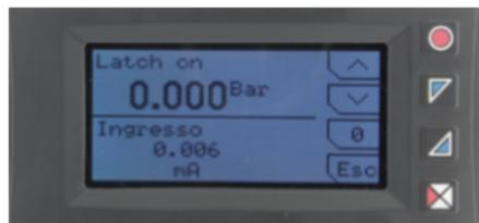
Per utilizzare la funzione LATCH ON, entrare in configurazione, impostare **Acquisizione** nel par. 8 **Latch on** e premere **Sel**: appare la schermata a lato.
