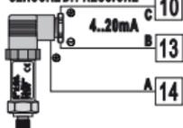
Per segnali normalizzati in corrente 0/4...20 mA con sensore a tre fili.
