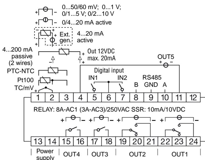
Fig. 2 - Connexions électriques
