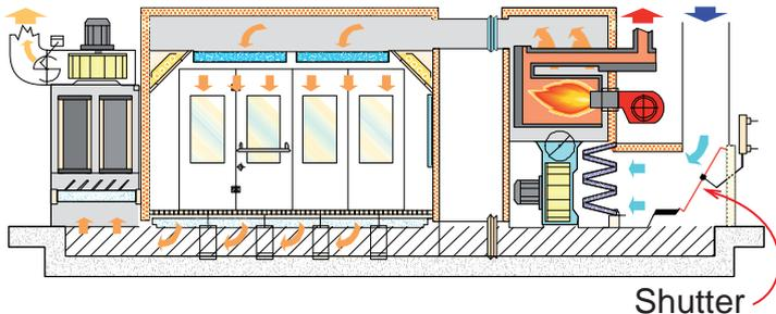
Pendant les phases de passivation et d'essiccation de la peinture, l'opérateur est à l'extérieur de la cabine et le système ferme la vanne de l'air extérieur et recycle l'air interne (déjà chaud) pour réduire la consommation d'énergie.
