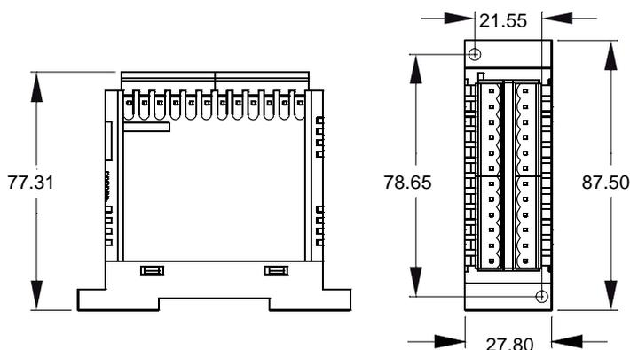
Fig. 1 - Dimensions du contrôleur
