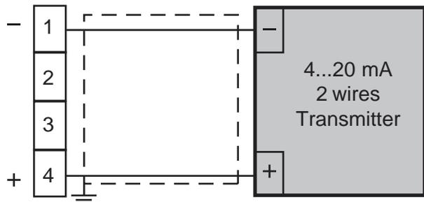
Fig. 8 - Câblage de signaux en 0/4... 20 mA à transmetteur passif avec alimentation auxiliaire
