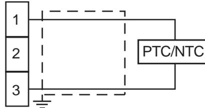
Fig. 6 - Câblage pour PTC/NTC
