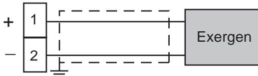
Fig. 4 - Câblage du capteur à infrarouge
