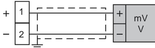
Fig. 7 - Câblage pour signaux en V/mV
