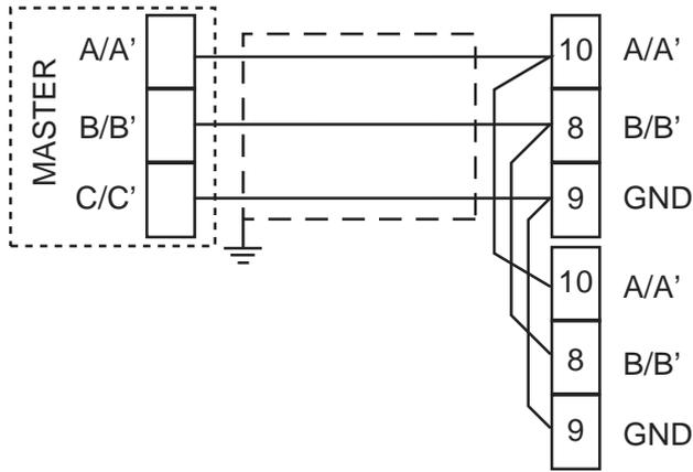
Fig. 11 - Câblage de l'interface de communication série
