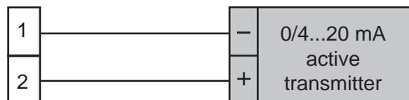
Fig. 10 - Câblage de signaux en 0/4... 20 mA à transmetteur actif
