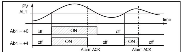
Une "Alarme relative inactive au changement de consigne" est une alarme qui masque les conditions d'alarme après un changement de point de consigne jusqu'à ce que la variable ait atteint le seuil d'alarme  $\pm$  hystérésis.
