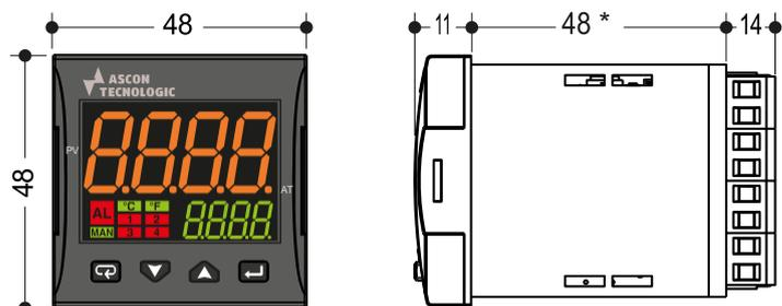
\* Dans les modèles avec alimentation universelle, le corps du régulateur est long de 63,3 mm
