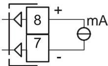
**Sortie mA:** 0/4... 20 mA, isolée, RL max. 500Ω.
