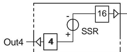
**Niveau logique 0:**  $V_{out} < 0.5 \text{ VDC}$ ;
