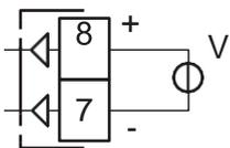
**Sortie V:** 0/2... 10 V, isolée, RL min.: 500Ω.
