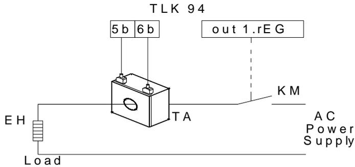
La première opération à effectuer pour avoir une mesure de courant correcte est celle à programmer au par. "IFS" le courant que l'instrument doit mesurer en correspondance du fond de l'échelle de l'entrée TA (50 mA).
