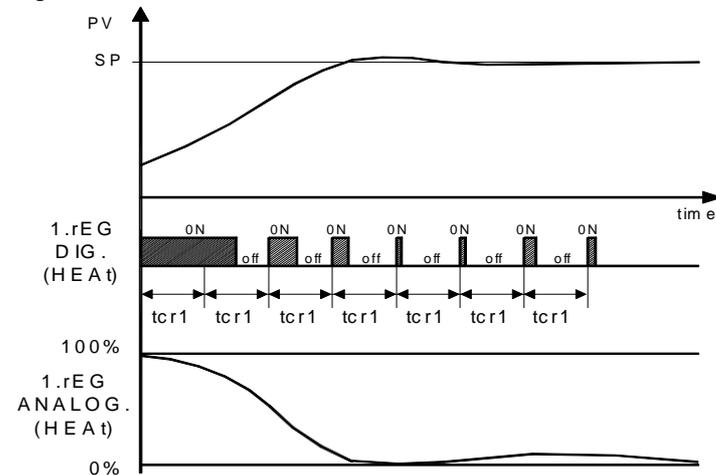
Pour obtenir une bonne stabilité de la variable dans le cas de procédés rapides, le temps de cycle "tcr1" doit avoir une valeur basse avec une intervention très fréquente de la sortie de réglage. Dans ce cas on recommande l'utilisation d'un relais statique (SSR) pour la commande de l'actuateur.
