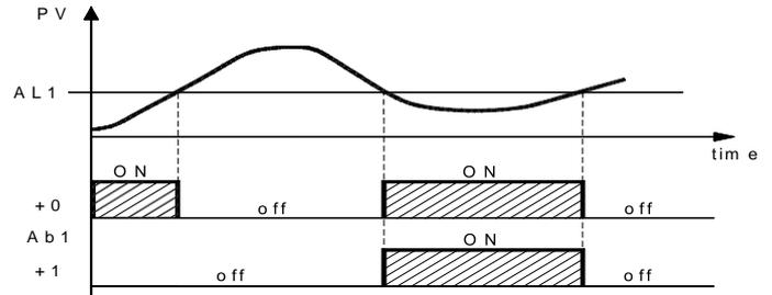
Dans l'exemple le comportement est représenté avec une alarme absolue de minimum
