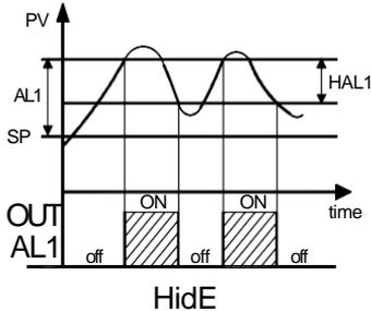
**LHAb** = ALARME ABSOLUE A FENETRE : L'alarme est activée quand la valeur de procédé descend sous le seuil d'alarme programmé au paramètre "AL1L" ou bien monte au-dessus du seuil d'alarme programmé au paramètre "AL1H"
