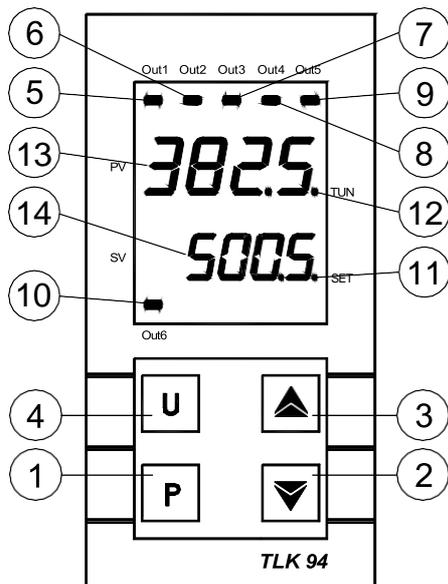
**1 - Touche P :** Utilisée pour accéder à la programmation des paramètres de fonctionnement et pour confirmer la sélection.
