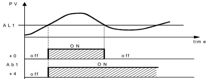
Dans l'exemple le comportement est représenté avec une alarme absolue de maximum.
