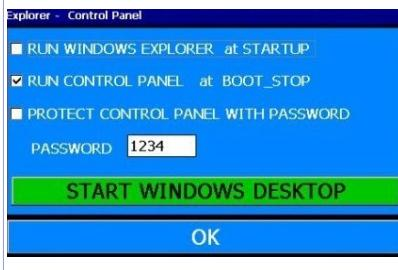
Da questa finestra è possibile scegliere un set di opzioni delle modalità di avvio di Windows CE ed esecuzione di TDControlPanel.
