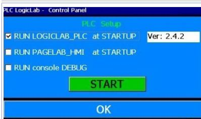
Da questa finestra si abilita/disabilita l'esecuzione del SoftPLC all'avvio del dispositivo. Selezionando il flag "RUN console DEBUG", durante l'esecuzione del SoftPLC, la finestra di Debug sarà compilata con gli eventi di sistema in tempo reale per poter verificare eventuali anomalie.
