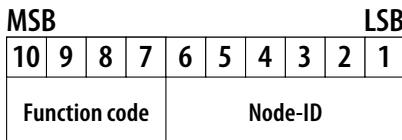
Pre-defined connection set definisce 4 Rx PDO, 4 TX PDO, 1 SDO, 1 Emergency Object e 1 Node-Error-Control Identifier. Supporta inoltre la trasmissione in broadcast di oggetti NMT Module Control Services, SYNC e Time Stamp. Lo schema di assegnazione di identificatore CAN completo è riportato nel seguente schema:
