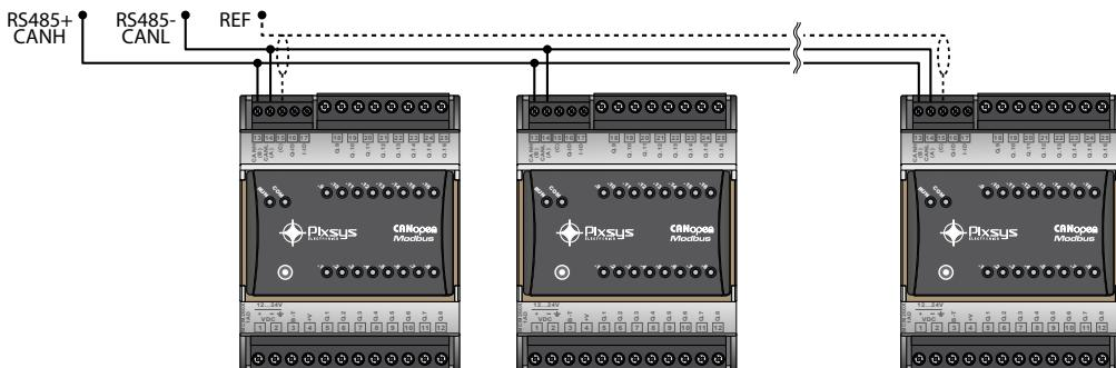
Si riporta di seguito lo schema di collegamento di più MCM260X ad una linea RS485 o ad una rete CAN.
