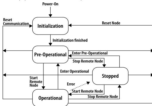
I servizi NMT consentono il cambiamento di stato in ogni condizione. I messaggi NMT sono formati da un CAN-header (COB-ID = 0) e 2 byte di dato. Un byte contiene il servizio richiesto (NMT command specifier) e l'altro contiene il Node-ID (0 per modalità broadcast). Una rete CANopen può avere un solo master NMT, che porta messaggi NMT e controlla i processi di inizializzazione.
