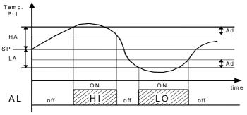
Les alarmes de température de maximum et de minimum peuvent être déconnectées en établissant les paramètres relatifs "HA" et "LA" = oF.
