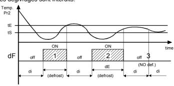
Exemples : le dégivrage 1 termine pour la réalisation de la température "tE", le dégivrage 2 termine à la fin du temps "dE" car la température "tE" n'est pas réalisée, le dégivrage 3 ne s'effectue pas car la température est supérieure à "tS".
