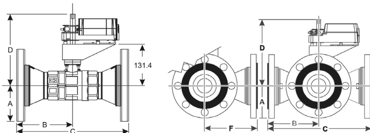
Dimensions en mm des vannes avec servomoteurs RETOUR A ZERO (avec ressort de rappel) D..F..20
