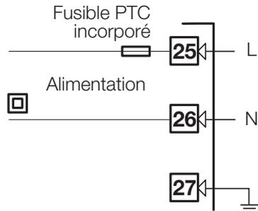
**Pour une meilleure immunité aux parasites, il peut être préférable de ne pas câbler la borne de terre si elle est déjà utilisée par l'installation tertiaire.**
