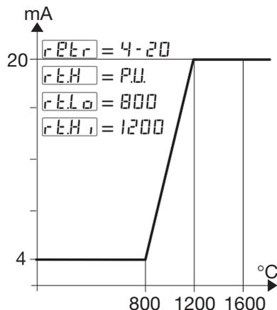
Avec le paramètre **rEtLo** supérieur à **rEtHi**, on obtient une échelle inverse.
