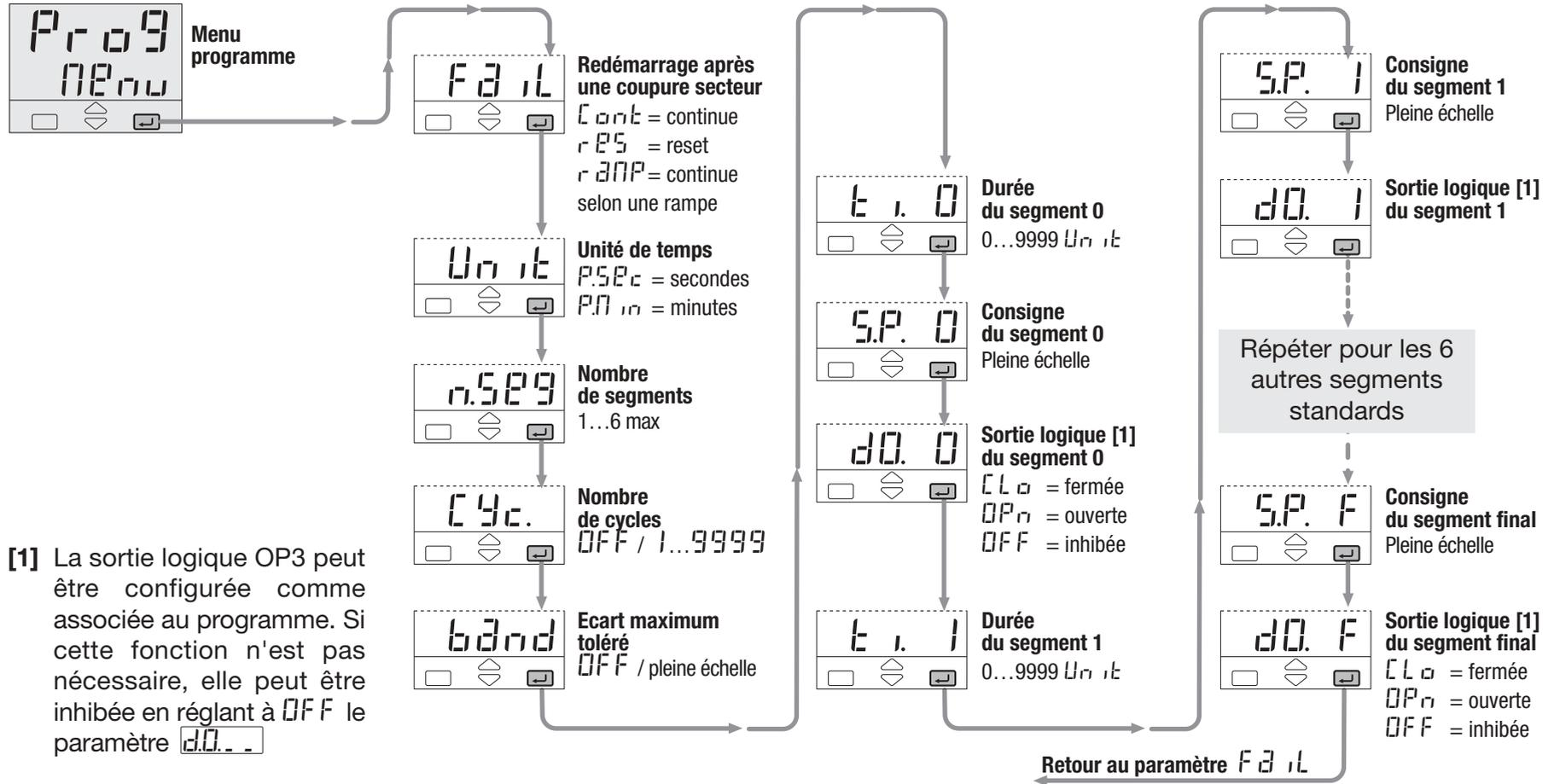
[1] La sortie logique OP3 peut être configurée comme associée au programme. Si cette fonction n'est pas nécessaire, elle peut être inhibée en réglant à OFF le paramètre **dO. \_ \_**
