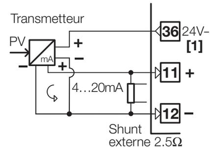
**[1]** Alimentation auxiliaire pour transmetteur 24Vdc  $\pm 20\%$ /30mA max, non protégée contre les courts-circuits
