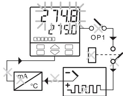
Avec OFF, l'alarme est de type rupture capteur simple avec action immédiate.
