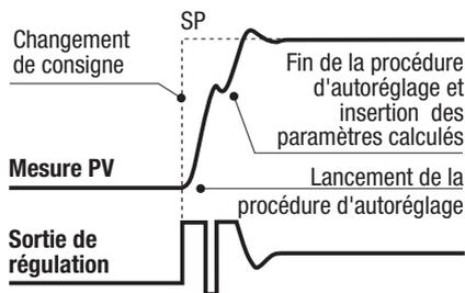
Ce mode est sélectionné quand au lancement de la procédure, la mesure est loin de la consigne de plus de 5% de l'échelle. Cette méthode a le grand avantage d'un calcul rapide avec une précision raisonnable.
