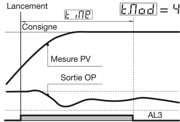
[1] Lorsque le timer n'est pas en cours, la sortie est forcée à 0. Il en est de même avant le lancement.
