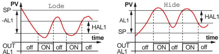
**LHAb** **Alarme de bande absolue:** l'alarme est **active** quand la mesure **descend en dessous** du seuil défini au paramètre  $AL1L$  ou **au-dessus** du seuil défini au paramètre  $AL1H$  et est **inactive** quand la mesure revient à l'intérieur de la bande  $[AL1H - HAL1 \div AL1L + HAL1]$ .
