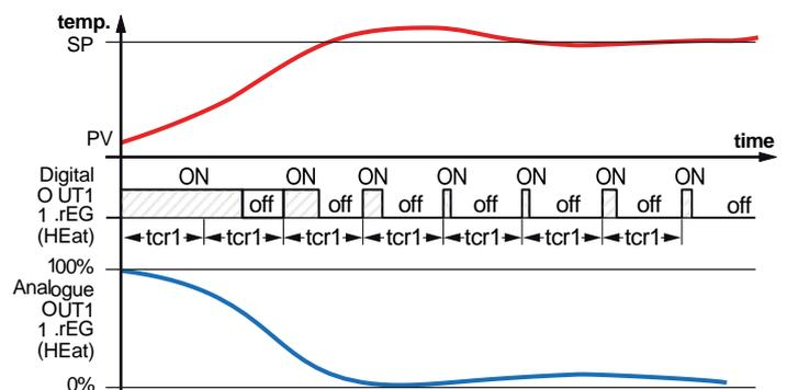
Pour obtenir une bonne stabilité de la variable PV dans le cas de procédés rapides avec sortie numérique, le temps de cycle  $tcr1$  doit avoir une valeur basse avec une intervention très fréquente de la sortie de réglage. Dans ce cas on recommande l'utilisation d'un relais statique (SSR) pour la commande de l'actuateur.
