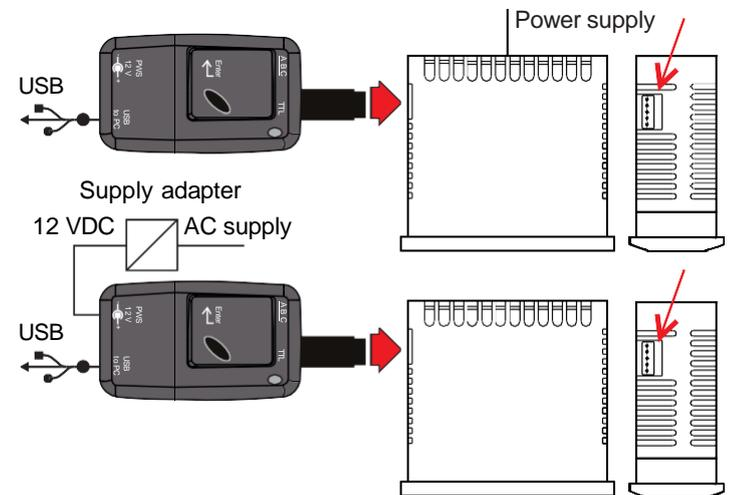
**Note:** Pour les instruments équipés d'un port de communication série RS485, il est essentiel, également pour l'utilisation de la clé **A01**, que **PACS = LorE**.
