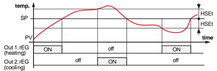
Si la sortie 2 . rEG est utilisé pour le commandement d'un compresseur il est utilisable la fonction Protection du compresseur a le but d'éviter des Départs rapprochés. Cette fonction prévoit un contrôle à temps sur l'allumage de la sortie 2 . rEG indépendamment par la demande du régulateur.
