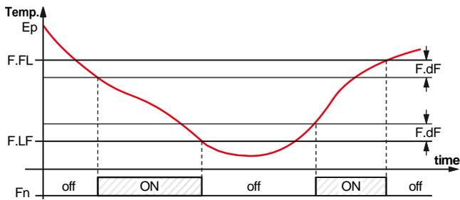
**Note:** Une attention particulière devrait être la correct utilisation des fonctions de contrôle des ventilateurs en fonction de la température parce que dans une application typique du ventilateur de l'évaporateur de réfrigération s'arrête bloquant le transfert de chaleur.
