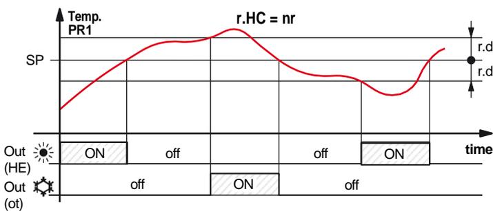
Si le paramètre "r.HC" = **nr**, alors la sortie configurée en "ot" fonctionne en **refroidissement** (comme si "r.HC" = **C**) et la sortie configurée en "HE" fonctionne en **chauffage**. Dans ce cas, la consigne de régulation (commune aux deux sorties) dépend du mode actif (**SP**, **SPE** ou **SPH**), de même que le différentiel d'intervention ("r.d", "r.Ed" ou "r.Hd") avec des valeurs positives pour le refroidissement et négatives pour le chauffage.
