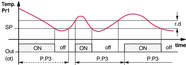
Pendant toutes les phases d'interdiction causées par les protections, le LED de la sortie (☼ ou ☼) est **clignotant**. En outre, on peut empêcher l'activation de toutes les sorties après l'allumage de l'instrument pour le temps établi au paramètre "p.od".
