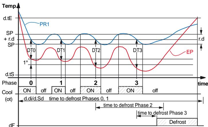
ex.: "Dynamic defrost intervals system" avec "réduction d.dd" = **40%** et fin de dégivrage par température.
