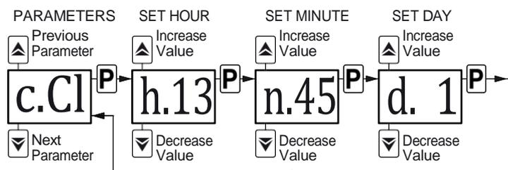
Sélectionner le paramètre "c.CL" et appuyer sur [P] plusieurs fois pour régler dans l'ordre :
