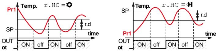
Selon le mode de fonctionnement programmé au paramètre "r.HC", le régulateur suppose automatiquement que le différentiel a des valeurs positives pour une commande de réfrigération ("r.HC" = **C**), des valeurs négatives pour le contrôle de chauffage ("r.HC" = **H**).
