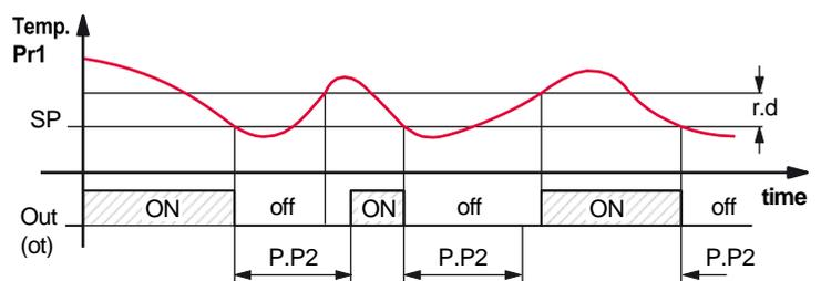
Le troisième contrôle prévoit une interdiction à l'activation de la sortie "ot" si, depuis que la sortie a été activée la dernière fois, le temps programmé au paramètre "P.P3" (retard entre les activations) n'est pas passé.
