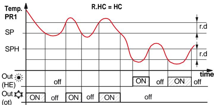
De la même manière, si le paramètre "r.HC" = **HC**, alors la sortie configurée en "ot" fonctionne en **refroidissement** (comme si "r.HC" = **C**) et la sortie configurée en "HE" fonctionne en **chauffage**.
