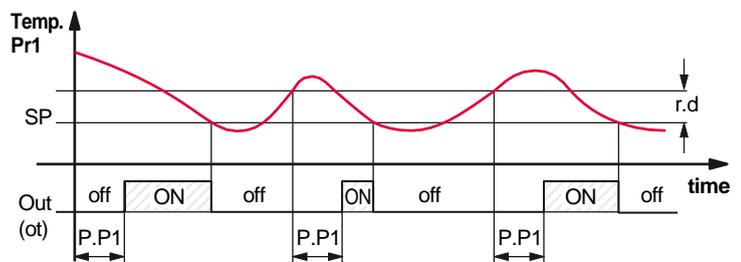
Le deuxième contrôle prévoit une interdiction à l'activation de la sortie "ot" si, depuis que la sortie a été désactivée, le temps programmé au paramètre "P.P2" n'est pas passé (retard après l'extinction ou temps minimum d'extinction).
