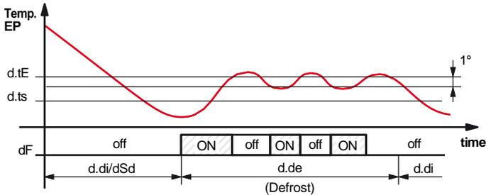
**Exemple de dégivrage électrique avec fonction de thermostat:** le dégivrage s’arrête à la fin des temps “d.de”. Pendant le dégivrage de la sortie configurée comme **dF** est activé/deconnecté comme un contrôleur de température tout ou rien en mode chauffage avec hystérésis de 1° afin de maintenir une température de dégivrage constante à la valeur “d.tE”. Le dégivrage actif est affiché à l’écran de l’appareil avec l’allumage de la LED ✨.
