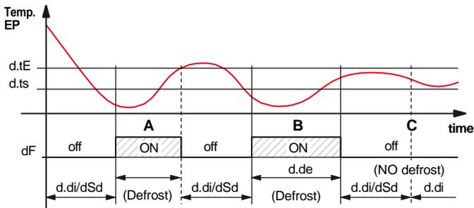
**Exemples du fin dégivrage:** le dégivrage **A** termine pour la réalisation de la température “d.tE”, le dégivrage **C** termine à la fin du temps “d.de” car la température “d.tE” n’est pas réalisée, le dégivrage **C** ne s’effectue pas car la température est supérieure à “d.ts”.
